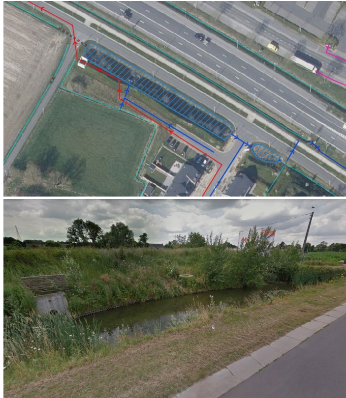
Figuur 38: Bufferbekken in de Molstraat. Op de figuur is de buis, die van de bewoning komt, te zien.
