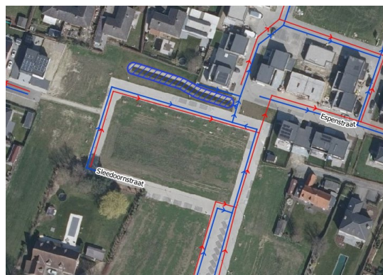
Figuur 39: Bufferbekken in de Sleedoornstraat, de wegen is reeds aangelegd. Nu de huizen nog.
