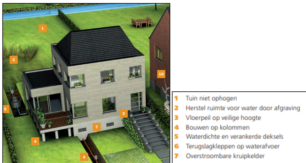
Figuur 87: Overstromingsgevoelig bouwen bij een nieuwe woning (Integraal Waterbeleid; (Integraal Waterbeleid, 2011))
