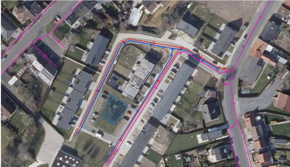
Figuur 43: Wadi in de Vlassersstraat, opvallend is dat er geen buizen naar toe zijn getrokken en dat er rond enkel parkeerplaatsen zijn, het water van de parkeerplaatsen zal dus afwateren.
