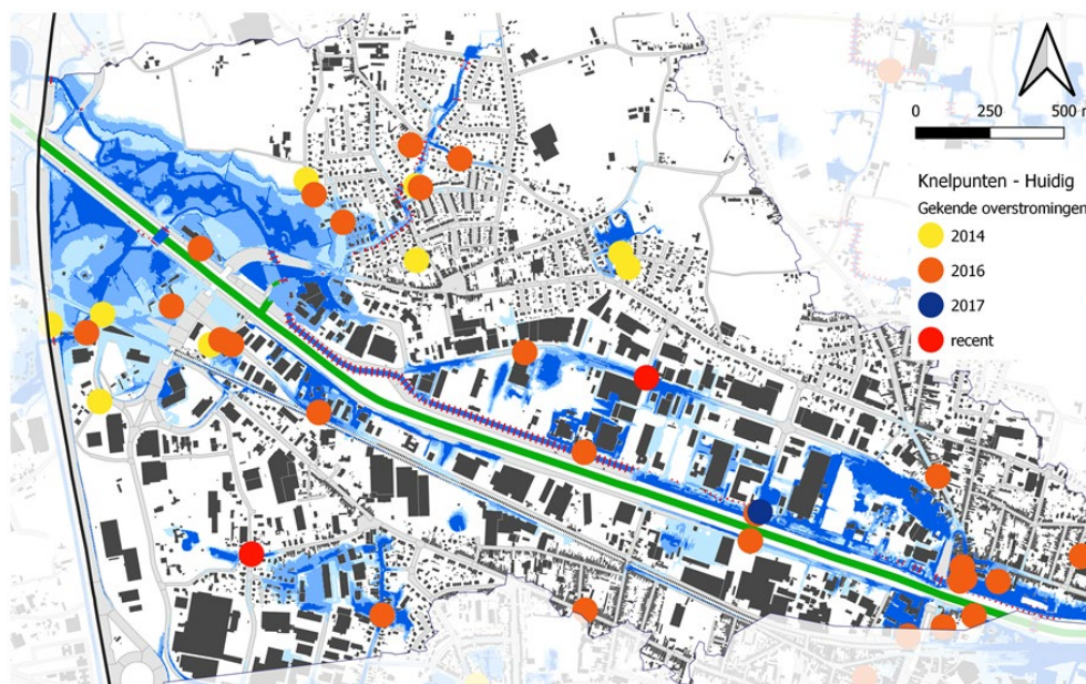
Figuur 105: Knelpunten gelinkt aan een melding bij de brandweer, dit toont dat de eerste deelzone zeker gekend is voor bepaalde wateroverlast. Het blauwe op de kaart toont de overstromingsgevoelige zones.
