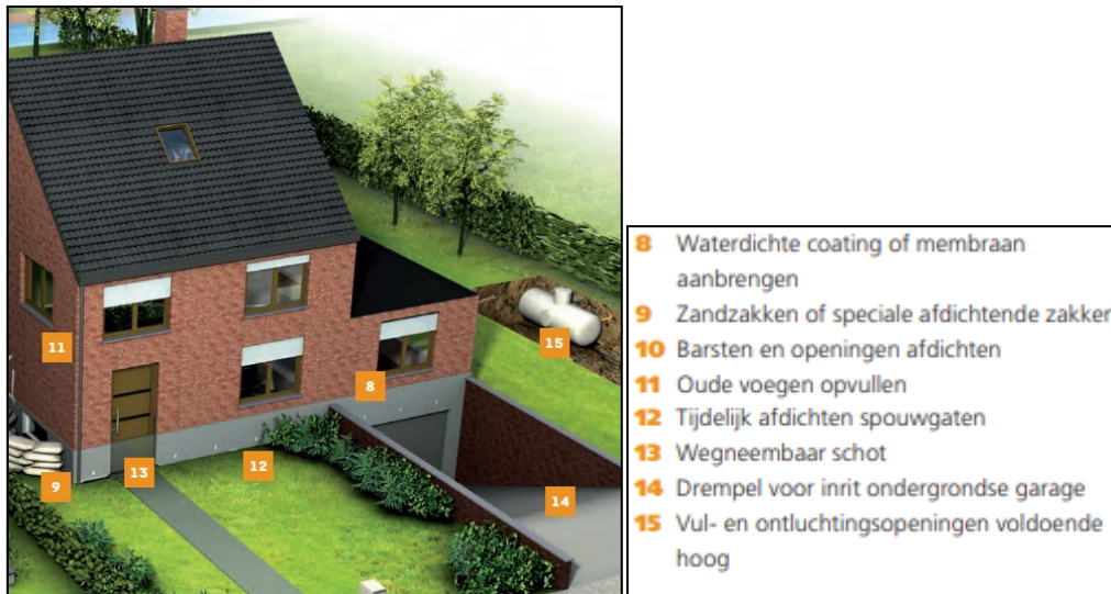
Figuur 86: Overstromingsgevoelig bouwen bij een bestaande woning (Integraal Waterbeleid; (Integraal Waterbeleid, 2011))
