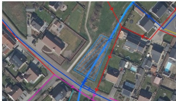
Figuur 34: Een bekken op Demuynckswalbeek die richting de Mandel stroomt. Rechts op de foto valt in het geel de overstortleiding op die op de beek loost.
